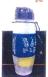
その後濾過器付きキャップを装着し、採取口から約  $100 \, \text{mL}$  をポリ瓶に注ぐ。この採取した溶液中の Cs 濃度の測定結果(サーモフィッシャーサイエンティフィック社製 ICP-MS(Element)によって測定)は  $6.8 \times 10^{-9} \, \text{g/L}$  となったが、今回の測定条件では検出下限値( $3\sigma$ )は  $7.1 \times 10^{-9} \, \text{g/L}$  であり、検出下限値以下であった。
